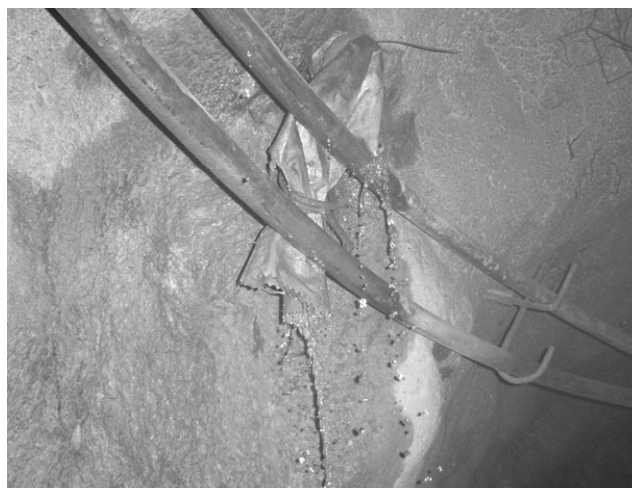
Figura 6.33. Manantial de agua con un flujo de 5 litros por minuto en una galería minera en la mina Yauliyacu (Perú). Foto: autores.
