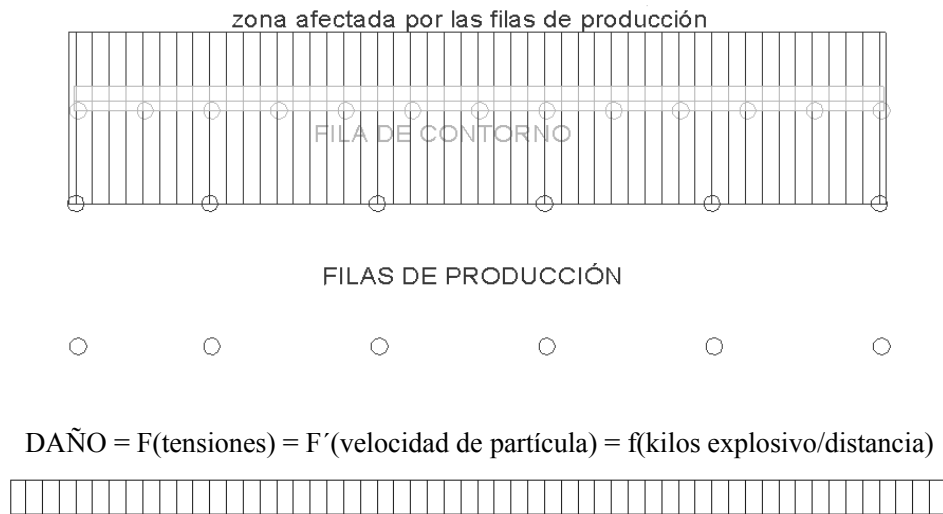
Figura 17.12. Extensión del daño por detrás de la hilera de contorno.
