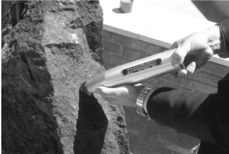
Figura 6.5. Martillo de Schmidt. Fotografía autores.
