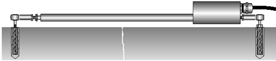
Figura 18. 35. Medidor de grietas (DGS)
